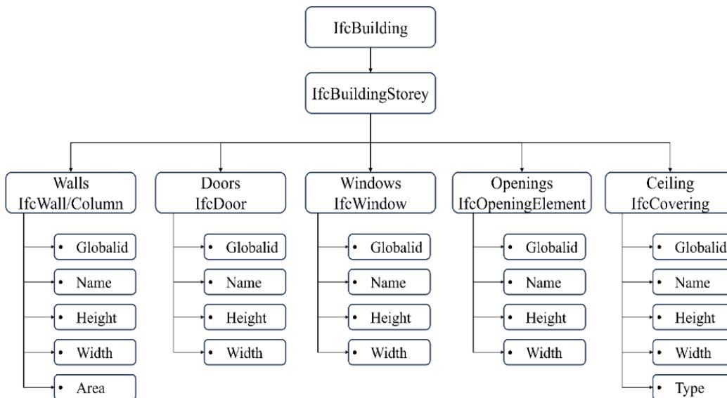
**Figure 3.** IFC element parameters
